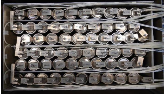
Abbildung 9 – Konfiguration der Zellen im Batteriemodul
