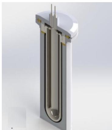
Abbildung 8 - Querschnitt der CERENERGY-Batterie
