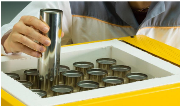
Abbildung 2 CERENERGY®-Zellen im Batteriemodul
