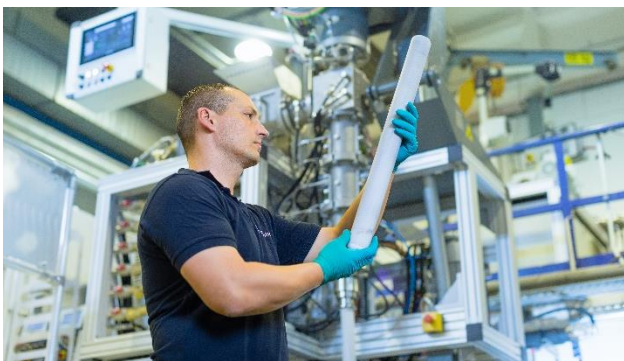
Abbildung 4 – Keramischer Festkörperelektrolyt in der IKTS Anlage
