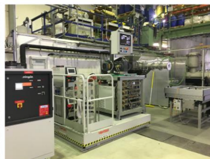
Großextruder 300 bar instrumentiert
